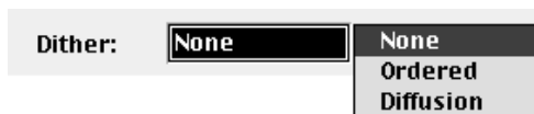
Rysunek 16.33. Format GIF posiada trzy opcje ditheringu dla kolorów, które nie znajdują się w aktualnej palecie kolorów.
